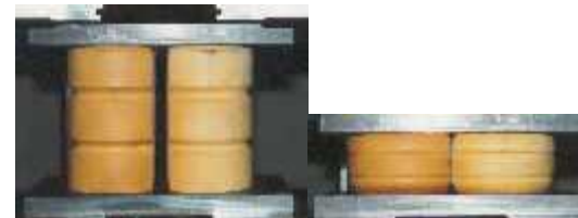
Elastomerpuffer/Dämpfer - entlastet und bei Bemessungslast
